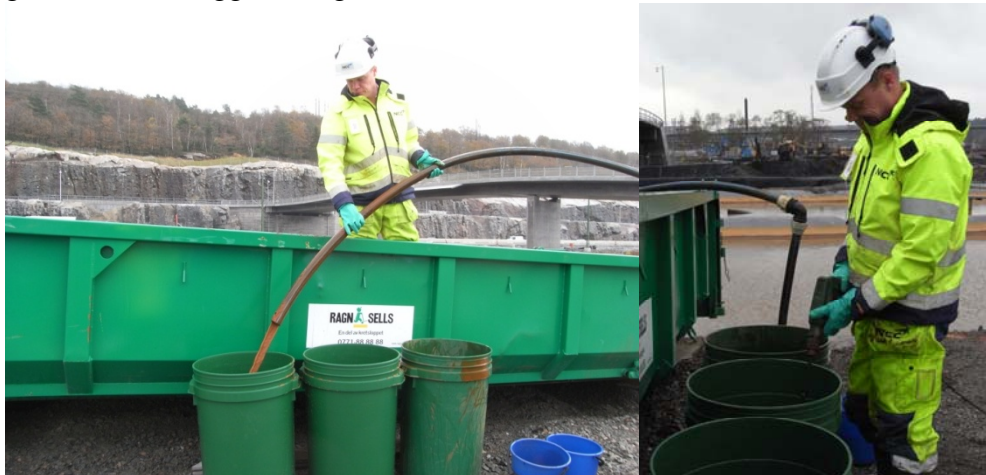
Figur 18. Uppumpning och omrörning av slam i 100 l tunnor.
