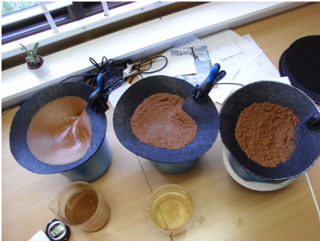
Figur 15. Slam vid polymerdos av 20, 40 och 80 ml/m 3 .
