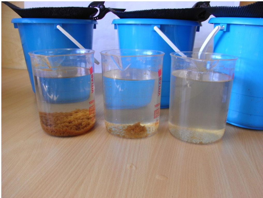
Figur 14. Filtrat (rejektvatten) vid dosering av 20, 40 och 80 ml/m 3 katjonisk polymer Zetag 9018.
