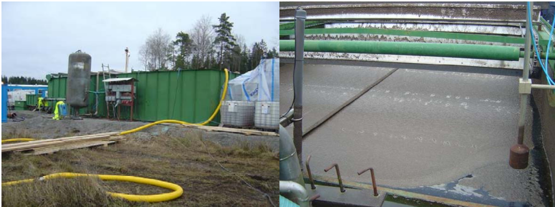
Figur 9. Flocknings-/flotationsanläggning, lakvattenrening (Milman Miljömuddring)
