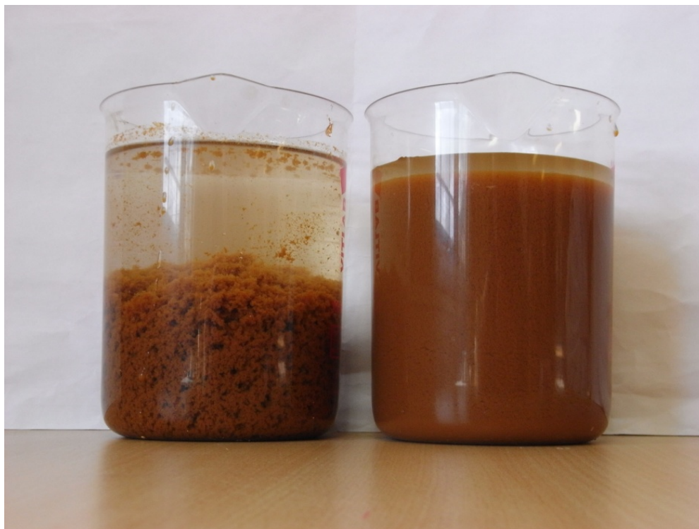
Figur 16. Slamprov med (till vänster) och utan tillsatt (till höger) polymer.
