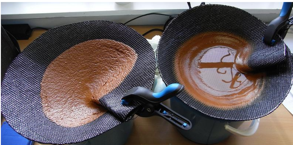
Figur 13. Skillnaden mellan två prover med lämplig (till vänster) och för låg (till höger) tillsatt mängd polymer.
