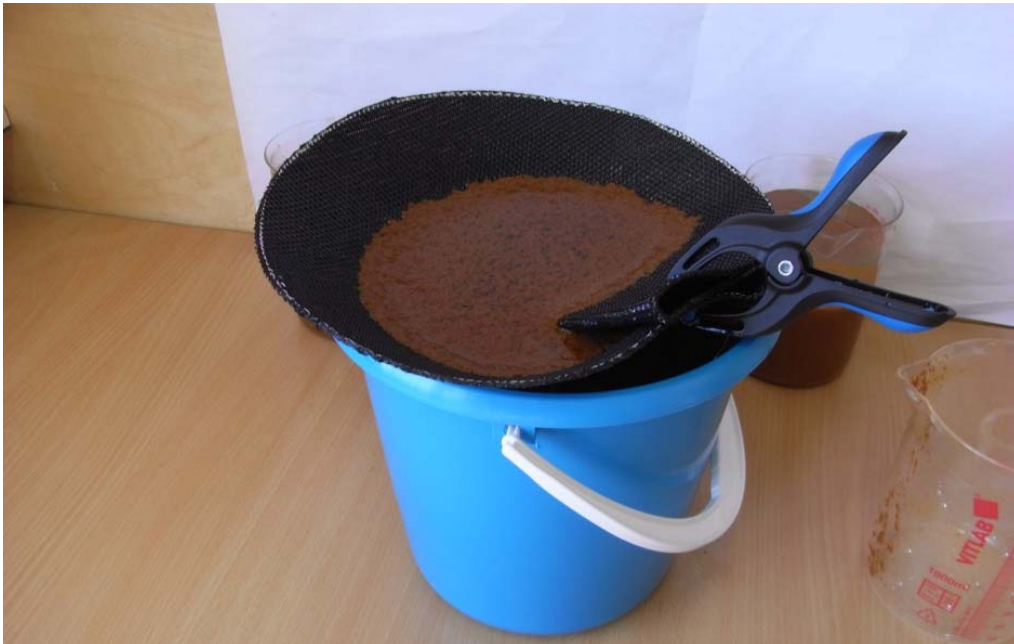
Figur 12. Utrustning för Bänkttest. Filtrering och uppsamling av vatten.
